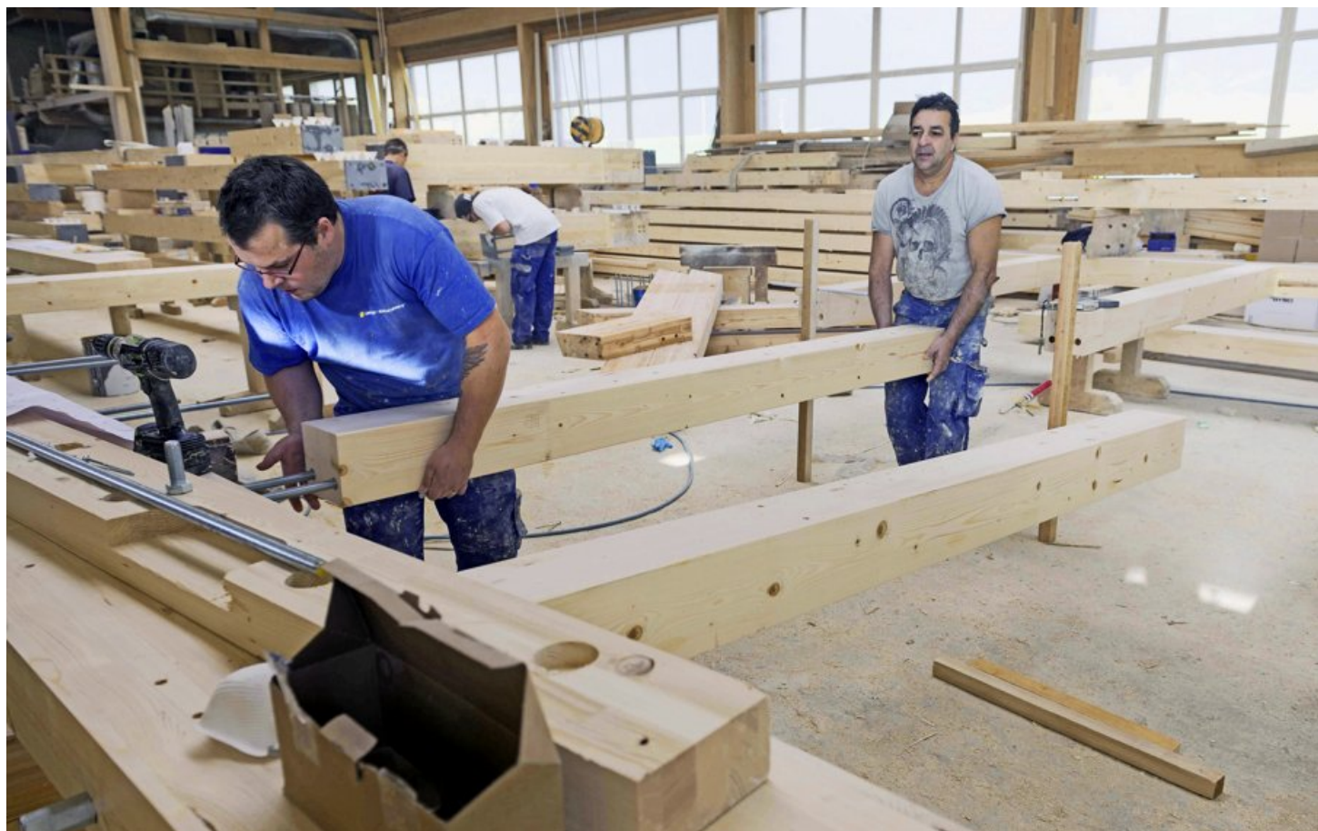
Les éléments de bois lamellé-collé sont assemblés à la main pour former des énormes kits de montage. JEAN-PAUL GUINNARD
