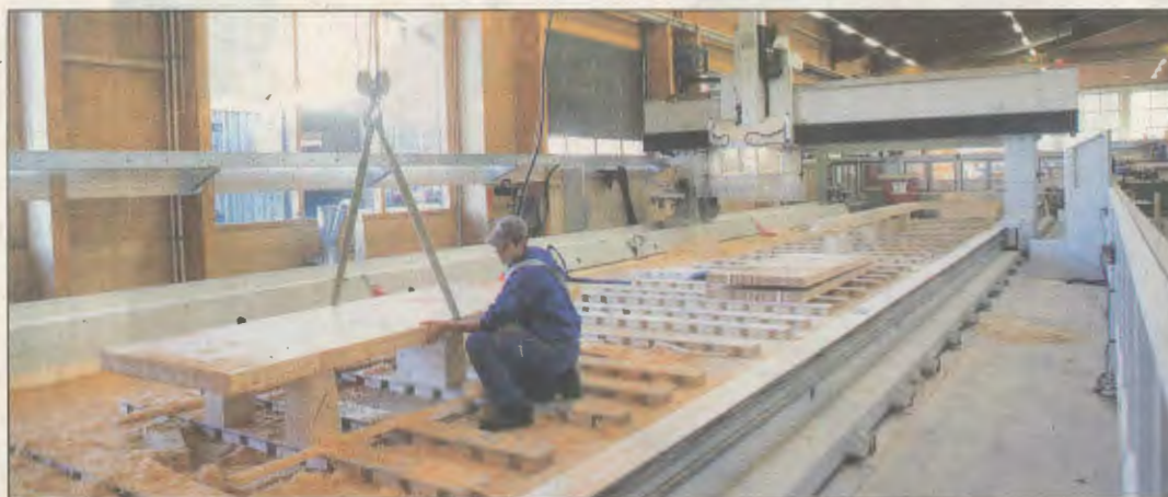
En fonction depuis la mi-octobre, la nouvelle machine CNC cinq axes permet à JPF-Ducret de travailler des pièces à la géométrie très particulière. Et de grande taille, au maximum 23 m de long et 3,3 m de large. CHLOÉ LAMBERT
